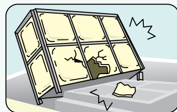
⑤ 检查蓄水箱外观有无损坏
