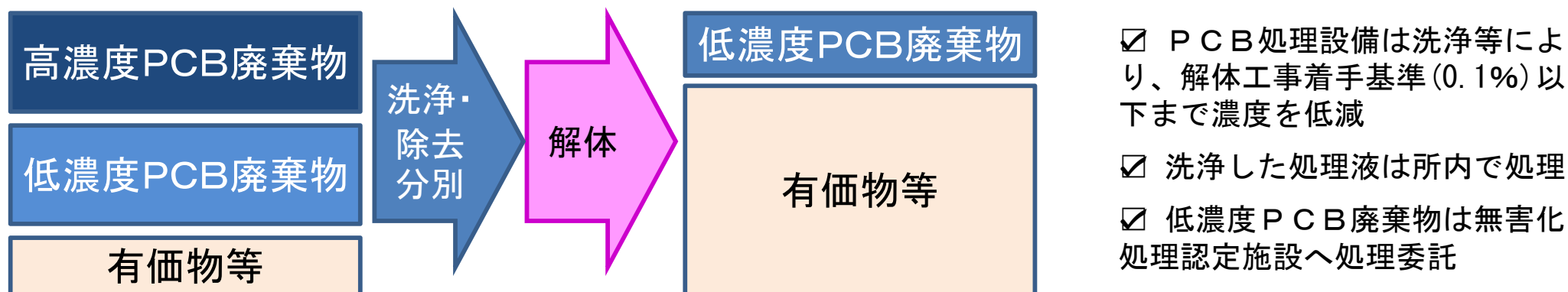
図. 高濃度・低濃度P C B処理設備に共通する洗浄・分別除去、解体のイメージ
