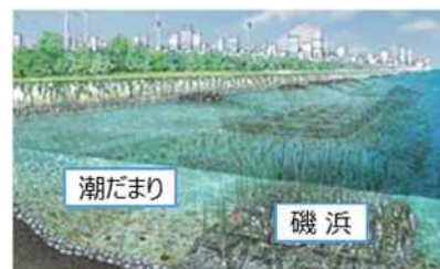
緩傾斜護岸を活用した磯浜等の整備
