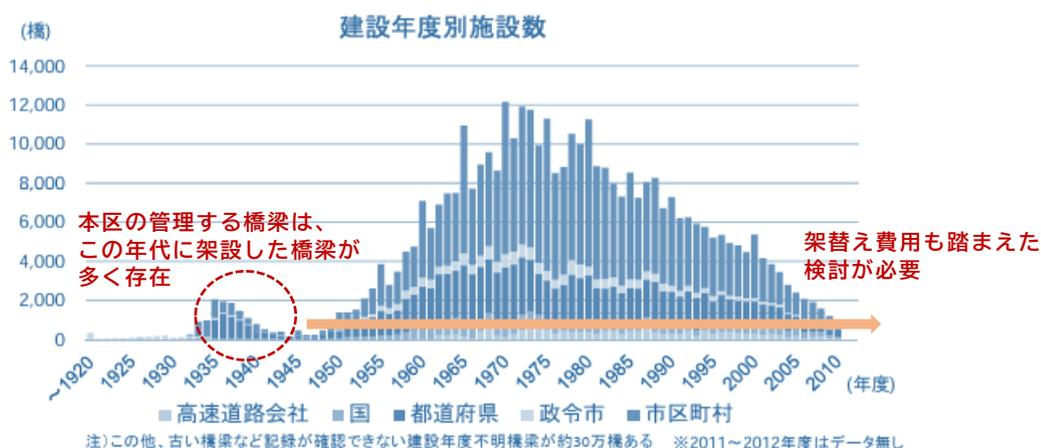
図 2.19 道路構造物の現状 (国土交通省 H25 道路局集計資料を編集)
