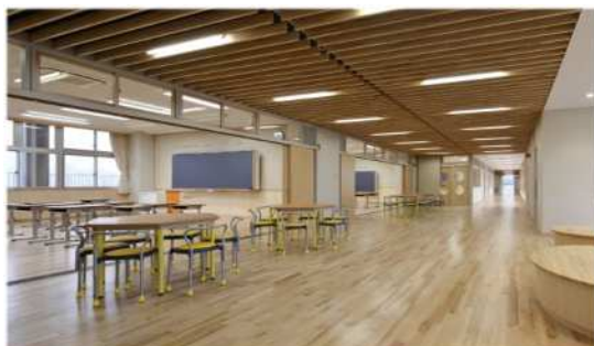
可動間仕切りにより廊下と一体になる教室
