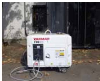
接続盤の電源コードを発電機に差し込むと電気が使用できます。
