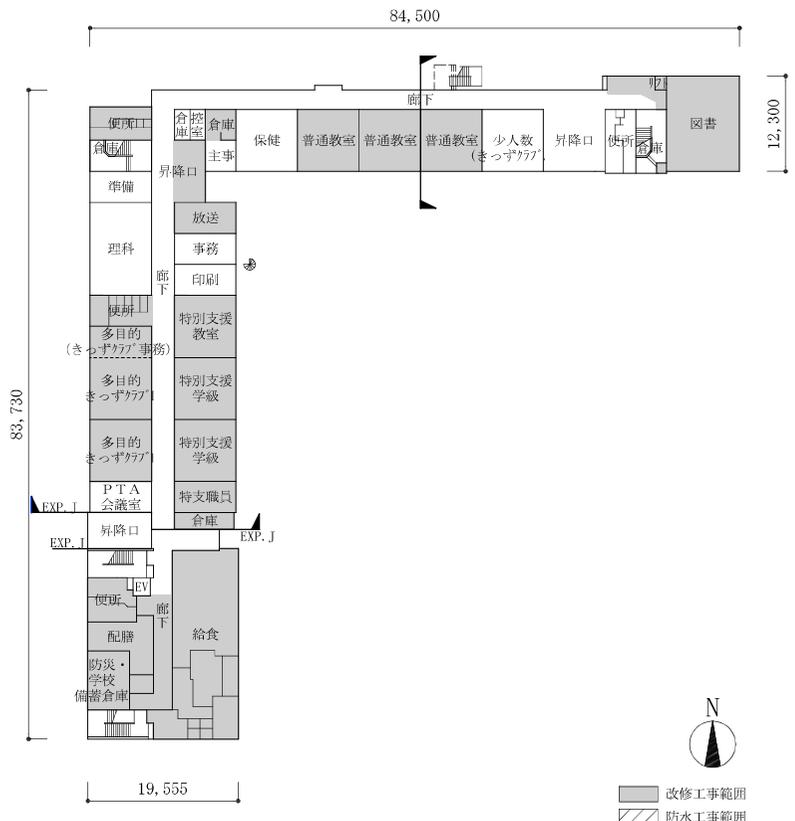
1階平面図 (改修後) SC=1:600
