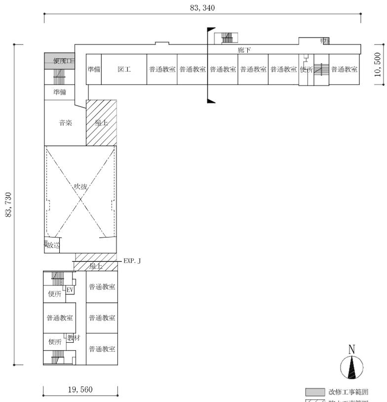
3階平面図 (改修後) SC=1:600
