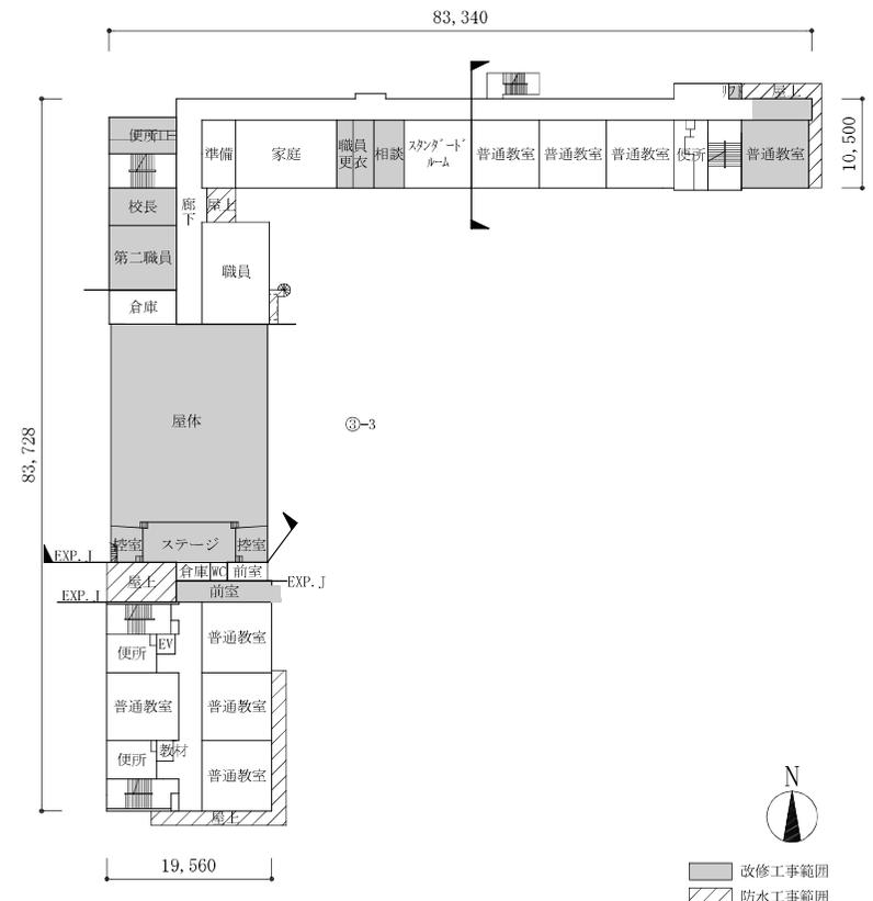
2階平面図 (改修後) SC=1:600
