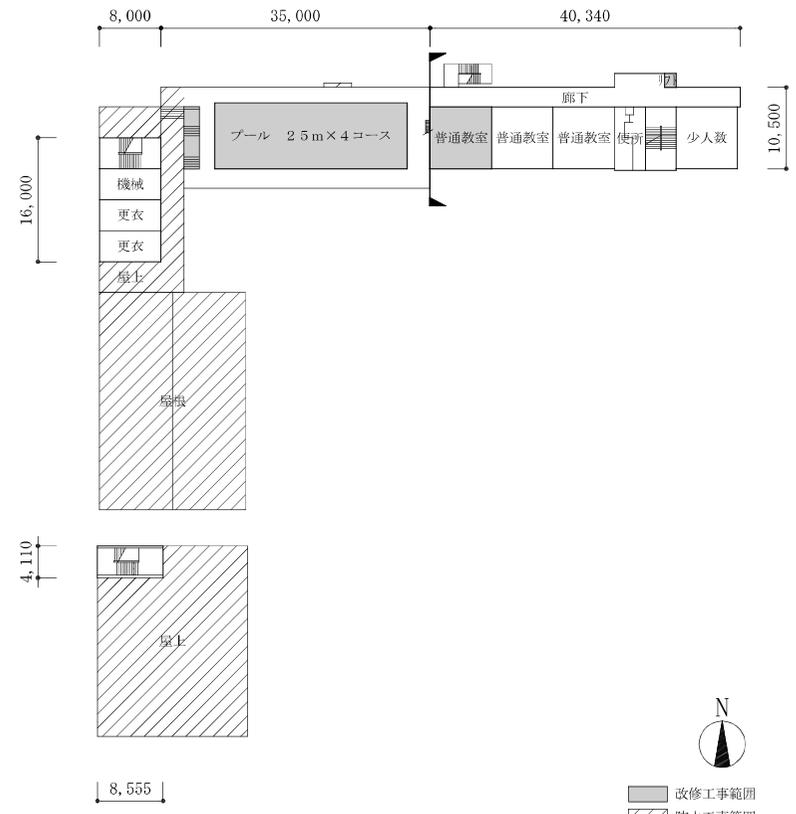
4階平面図 (改修後) SC=1:600
