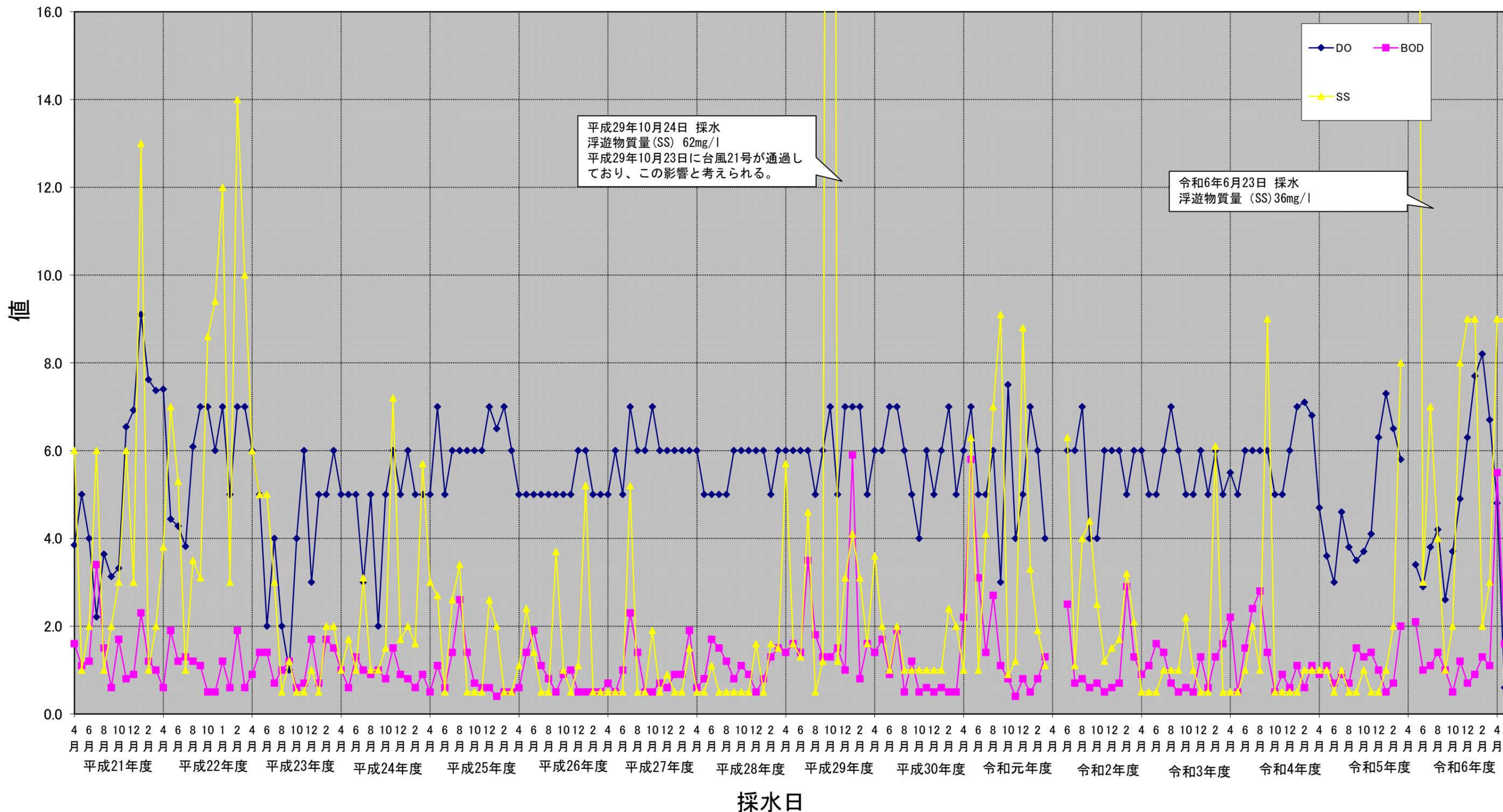
調査項目は、①DO：溶存酸素量 ②BOD：生物化学的酸素消費量 ③SS：浮遊物質 量の3項目です。
