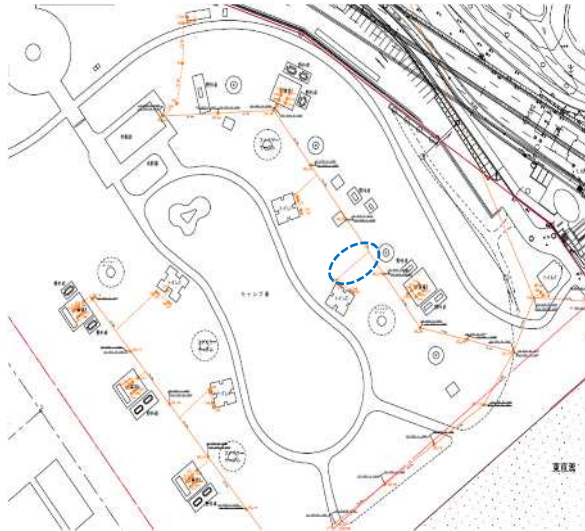
図表 交換対象排水管位置図
