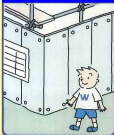
工事用仮囲い、 足場を設置する
