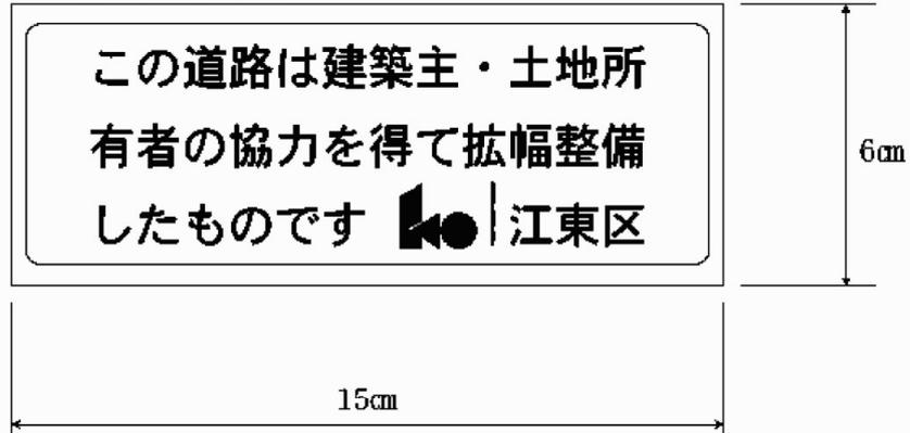
材質：アルミプレート 厚み0.8mm
