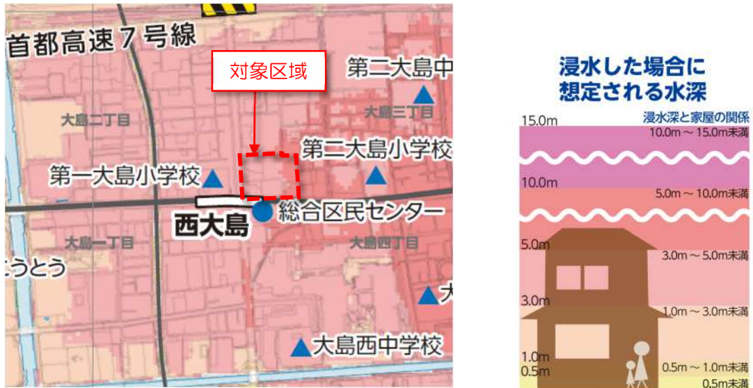
図：高潮氾濫による浸水の深さ
