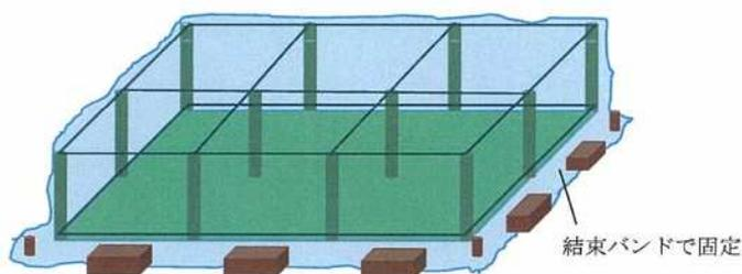
※防除網の高さはウミネコが網の上に乗っても地面まで沈まず、かつ屋上の強風で飛ばされないように、400mm～1,000mm程度を維持するのが好ましい。
