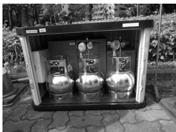
大気試料の採取装置
