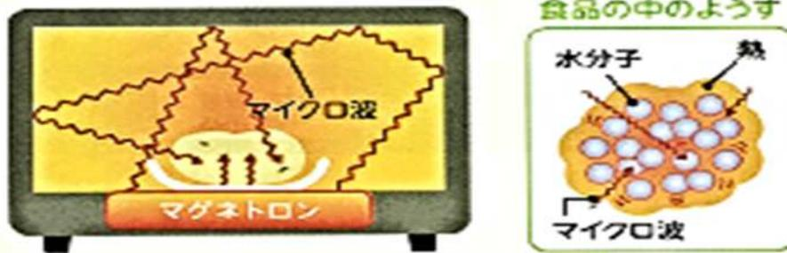
スタートボタンを押すと、「マグネトロン」という装置からマイクロ波という電波が出て、食品に吸収されます。すると、食品に含まれているたくさんの水分子が振動し、ぶつかったりこすれあったりして、熱が乗じます。この熱により、食品そのものを加熱します。
