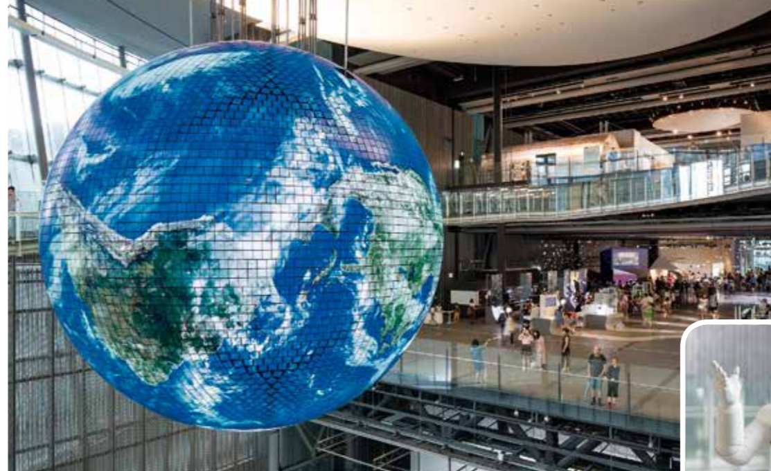
直径約6mの「ジオ・コスモス」。有機ELパネルに、気象衛星から取り込んだ実際の雲のデータなどが映ります
