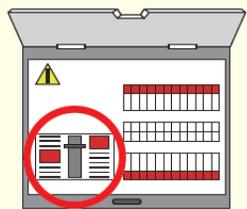
分電盤に内蔵されたセンサーが揺れを感知し、ブレーカーを落として電気を遮断
