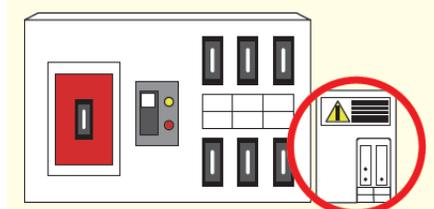
分電盤に感震機能を外付けするタイプ。漏電ブレーカーが設置されている場合に設置可能
