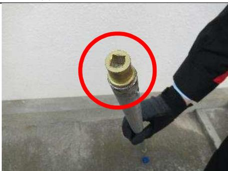
給水弁の開栓時には、四角形でくぼんだ鍵穴(赤枠)を使用してください。
