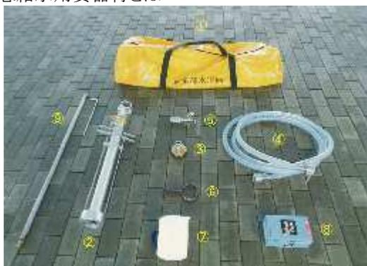
応急給水用資器材とは、応急給水栓にセッティングする器材となります。
