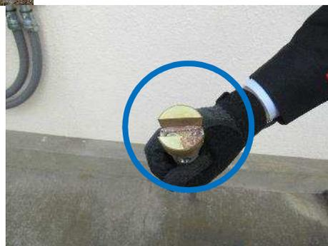
開栓器の鍵穴は、給水栓をあける鍵穴(赤枠)と仕切弁を開栓する鍵穴(青枠)の2種類あります。
