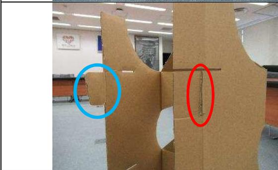
青枠部を山折りに折り曲げた後に、青枠部を赤枠部（縦に切り込みが入っている部分）に差し込みます。3か所に差し込みます。
