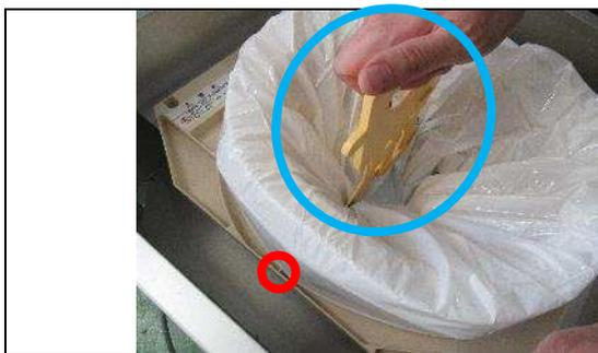
①ジグリンを天板の突起(赤枠)に合わせて抵抗がなくなるまで押し込みます。(青枠)
