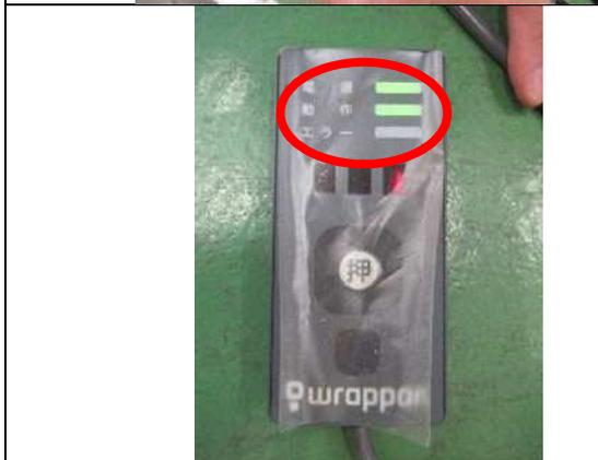
②ピーピーピーと音が鳴り、手元スイッチの電源ランプが緑色に点灯します。
