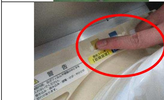
③黄色スイッチ【初期設定】(赤枠)を押します。スイッチを押して1分待ちます。
