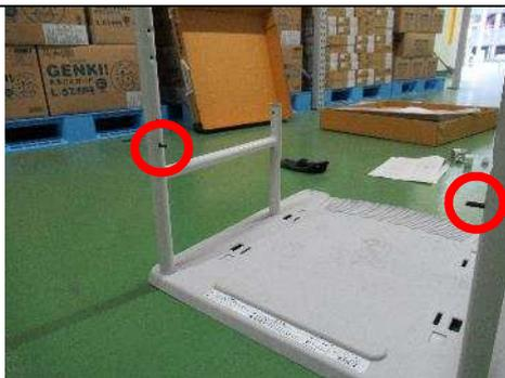
①パイプの1番下の穴にねじ(細)2個を仮止めします。
