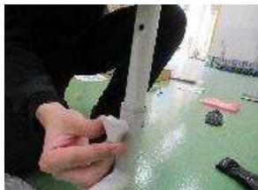
②調節ねじで4か所固定します。内側からねじを止めてください。
