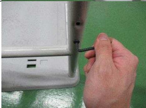
②六角レンチを用いて補強棒を固定します。
